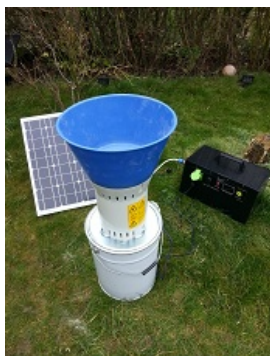
Le moulin à grain avec son équipement solaire
